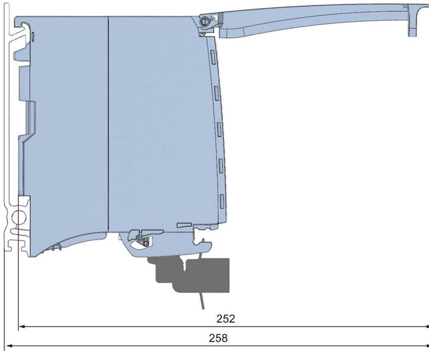
Рисунок А-2 Габаритный чертеж модуля AI 8xU/R/RTD/TC HF (вид сбоку, открытой передней крышкой)
